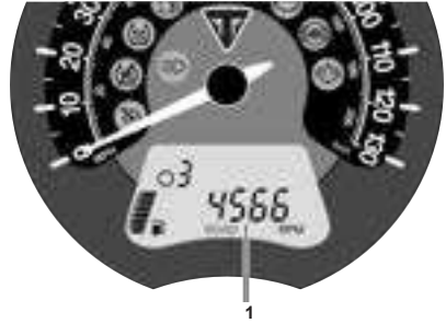
1. Motor devri rpm cinsinden gösterilir
